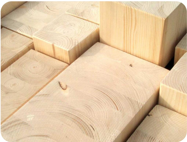
vuren GL24h met Nanoskin coating
